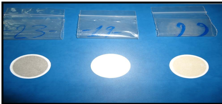
صورة (1) : نماذج لفلاتر قياس الدقائق العالقة والعناصر الثقيلة في هواء محافظة بغداد
